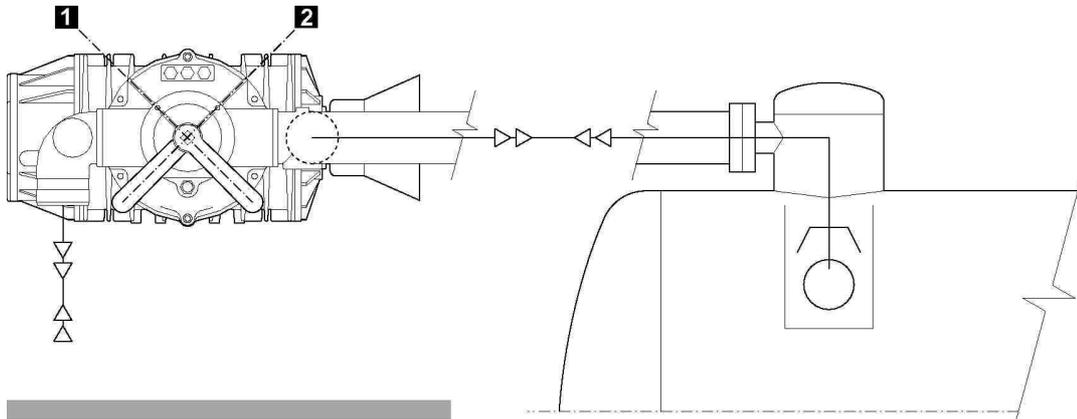
Обычно конвейер/коллектор с резьбовым соединением для клапана избыточного давления установлен в передней части насоса. Однако, если необходимо, его можно переместить в заднюю часть. В этом случае, функция разрежение-давление будет противоположной описанной.
